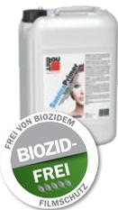
Mineralische Grundierung zur Verfestigung von mineralischen Oberflächen vor Anwendung von mineralisch oder organisch gebundenen Putzen und Farben. Zum Verdünnen von SanovaColor und KlimaColor geeignet, lösemittelfrei, farblos, für außen und innen. Ggf. kann eine gleichmäßige Verdünnung mit Wasser bei der Putzverfestigung in einem maximalen Verhältnis von 1:1 erfolgen.
