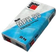
Beschleunigter Kalk-Zement-Haftputz, hervorragende Untergrundhaftung, speziell als Einlagenputz für Betonwände und -decken, **nicht** als Haftbrücke oder Armierungsputz einsetzbar. Auch bei erhöhter Betonrestfeuchte verwendbar, für außen und innen sowie für Feuchträume, aber nicht als Fliesenuntergrund, gut filzbar. Geprüft wohngesund. DIN 18550: P II; DIN EN 998-1: GP, CS III, W<sub>c</sub>2.
