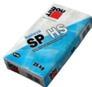
Grauer, porenhydrophober Sanierputz mit selbstaktiver Porenbildung, Bindemittel mit hohem Sulfatwiderstand, zur Sanierung von feuchtem und salzhaltigem Mauerwerk (z. B. bei Nitrat-, Chlorid- und Sulfatbelastung), für außen und innen. Mit Putzmaschinen ohne Zusatzausrüstung verarbeitbar, nach WTA\* 2-9-20/D zertifiziert. DIN 18550: P II; DIN EN 998-1: R, CS II, W<sub>c</sub>2.
