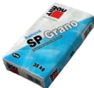
Porenhydrophober Sanierputz mit selbstaktiver Porenbildung, zur Sanierung von feuchtem und salzhaltigem Mauerwerk (z. B. bei Nitrat-, Chlorid- und Sulfatbelastung), für außen und innen, mit Putzmaschinen ohne Zusatzausrüstung und händisch verarbeitbar, nach WTA\* 2-9-20/D zertifiziert. Geprüft wohngesund. DIN 18550: P II; DIN EN 998-1: R, CS II, W<sub>c</sub>2.
