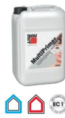
Ultrafeindisperser Hydrosol-Tiefengrund. Für egalisierende Grundbeschichtungen auf porösen, saugenden und sandenden Putzen, Beton, Kalksandstein, Sichtmauerwerk und Gipskartonplatten. Besonders tiefes Eindringvermögen, lösemittel- und ammoniakfrei, leicht grün eingefärbt, für außen und innen. Verarbeitungsfertig. Verdünnung mit Wasser max. im Außenbereich 1:1, im Innenbereich je nach Saugfähigkeit 1:3 bis 1:5.
