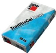
Faserverstärkter, naturweißer Renovier- und Haftputz zum Ausgleichen und als Haftbrücke auf tragfähigen Altputzen mit und ohne Altanstrichen, für innen und außen. Besonders geeignet für den historischen Bereich. Diffusionsoffen und wohnklimaregulierend. DIN 18550: P I; DIN EN 998-1: GP, CS I, W<sub>c</sub>1.
