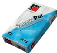
Porenhydrophober Ausgleichs- bzw. Porengrundputz mit selbstaktiver Porenbildung, zur Sanierung von feuchtem und salzhaltigem Mauerwerk (z. B. bei Nitrat-, Chlorid- und Sulfatbelastung), für außen und innen, mit Putzmaschinen ohne Zusatzausrüstung verarbeitbar, nach WTA\* 2-9-20/D zertifiziert. Geprüft wohngesund. DIN 18550: P II; DIN EN 998-1: GP, CS III, W<sub>c</sub>2.
