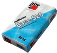
Universalprodukt für den Sockelbereich. Einsetzbar als Haftbrücke, auch auf bituminösen Untergründen, als Unter- und Oberputz auf mineralischen Untergründen sowie als Klebemörtel für Dämmplatten und als Armierungslage und gefilterter Oberputz im Sockelbereich. Bei einer Gesamtputzdicke von mindestens 7 mm ist eine zusätzliche Putzabdichtung nicht notwendig. DIN 18550: P II; DIN EN 998-1: GP, CS IV, W<sub>c</sub>2
