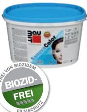
Leicht verarbeitbare Sol-Silikat-Fassadenfarbe mit guter Untergrundhaftung. Trocknet spannungsarm und nicht filmbildend auf. Airless spritzbar. Auf Grund der sehr hohen Wasserdampfdurchlässigkeit gut geeignet für die Sanierung auch im Denkmalschutz. Nach DIN EN 1062-1: G3, E3, S1, V1, W2, A0, C0. Sehr hoch wasserdampf- und CO<sub>2</sub>-durchlässig, verdünnbar mit Baumit SanovaPrimer, für außen, weiß oder farbig lieferbar.
